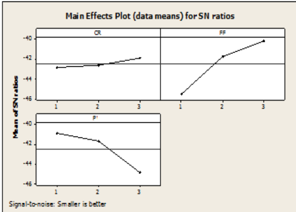
Fig. 9. SN Ratio for NO x of NOME
